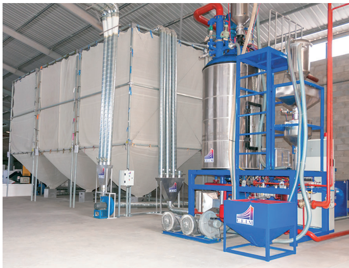
Machine à fabriquer des billes de polystyrène et silo à bille
