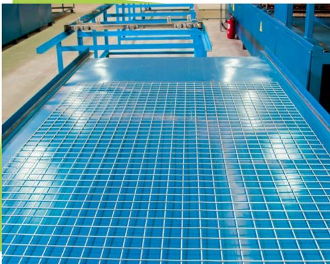
*PolyArm est simple à découper et à mettre en place. Il se pose directement sur le support ou dans une couche de mortier et se fixe à l'aide de cordons soudés ou d'agrafes. Il peut être utilisé dans les deux sens et s'adapte facilement à chaque type de chantier.*
